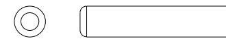
Ø 6mm Wood Dowel Ø 6mm Clavija de madera Ø 6mm Goujon en bois
